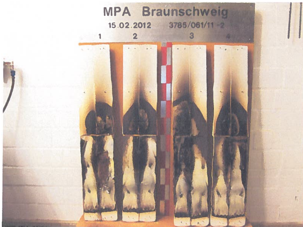
Ansicht der Sistem Metal – Prüfkörper B nach der Brandschachtprüfung (Versuch 2)
