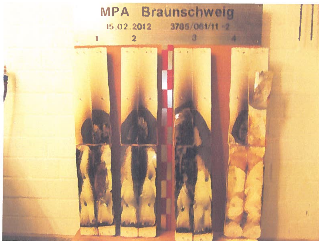
Ansicht der Sistem Metal – Prüfkörper B nach der Brandschachtprüfung (Versuch 2), bei Prüfkörper 4 wurden die Deckbleche entfernt
