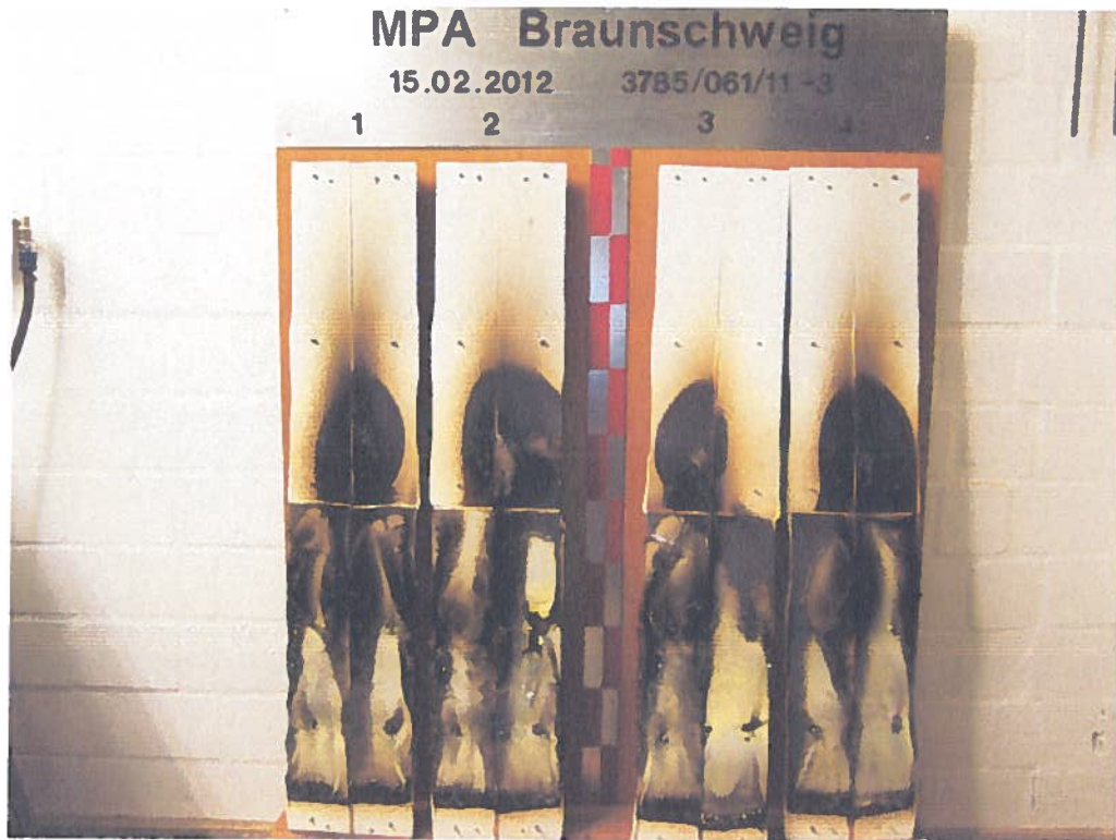
Ansicht der Sistem Metal – Prüfkörper C nach der Brandschachtprüfung (Versuch 3)
