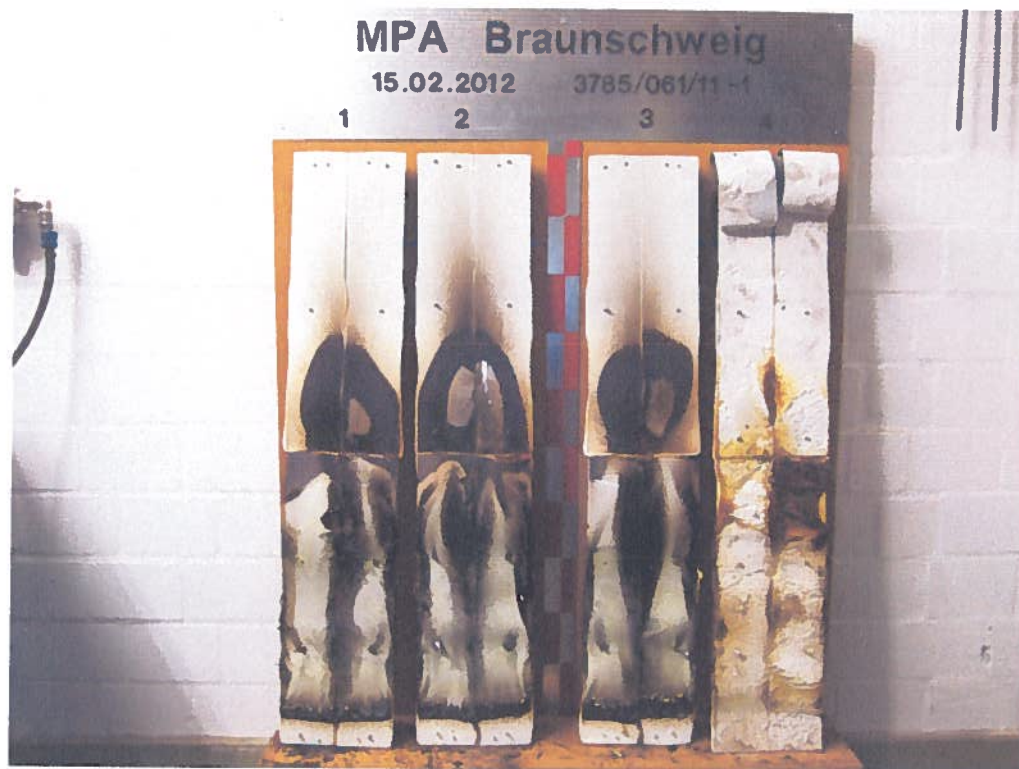
Ansicht der Sistem Metal – Prüfkörper A nach der Brandschachtprüfung (Versuch 1), bei Prüfkörper 4 wurden die Deckbleche entfernt
