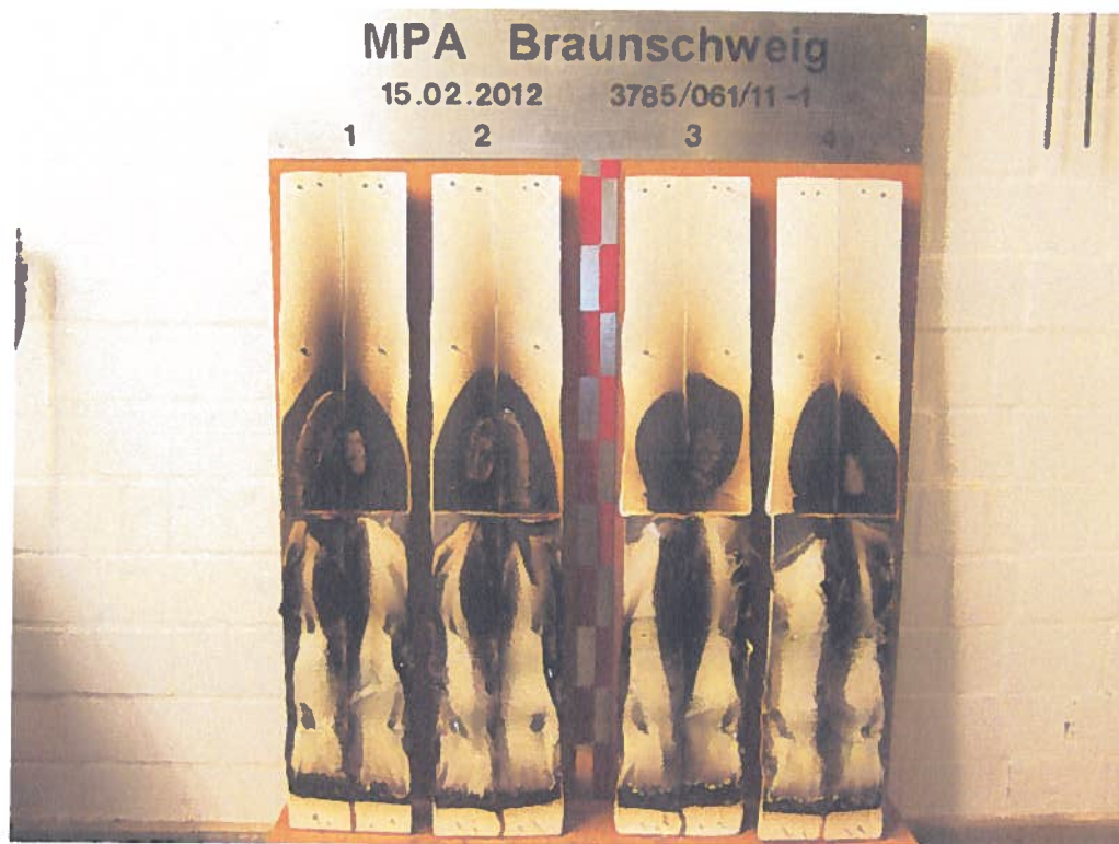
Ansicht der Sistem Metal – Prüfkörper A nach der Brandschachtprüfung (Versuch 1)
