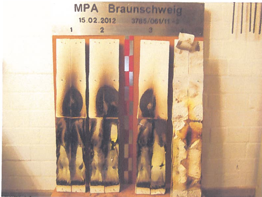
Ansicht der Sistem Metal – Prüfkörper C nach der Brandschachtprüfung (Versuch 3), bei Prüfkörper 4 wurden die Deckbleche entfernt
